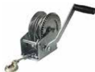
Лебедка ручная барабанная. Удобная и простая в обращении ручная лебедка, данная лебедка имеет широкий спектр использования, может использоваться для подтягивания различных грузов, для удержания грузов при перевозке на прицепах, грузоподъемность лебедки рассчитывается как 75% от тягового усилия. Лебедка не предназначена для удержания груза на высоте без дополнительного крепления груза. Запрещается подъем и перемещение людей. Тяговое усилие 1100 кг, длина каната 20 м, d=5,6 мм.
