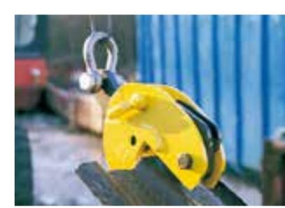
Предназначен для подъема в вертикальное положение за одну сторону шпунта и последующего его монтажа, с возможностью дистанционной расстроповки.
