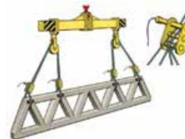
Штыревые замки (замки Смаля) используются совместно с канатным стропом и служат для удобной расстроповки груза, например, на высоте. Замок представляет собой каркас с подвижным штырем, который огибает канат при строповке груза. После установки груза на место и ослабления стропа штырь выдергивается и грузозахватное устройство освобождается.
