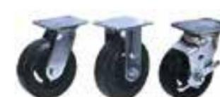
**Scd, Fcd, Scdb** — колесные опоры большегрузные неповоротные, поворотные и поворотные с тормозом, контактный слой из литой черной резины, чугунная ступица, платформенное крепление, игольчатый подшипник.
