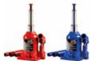
Телескопический бутылочный домкрат представляет собой устройство с ручным приводом, которое используется для поднятия грузов при минимальных физических затратах оператора. Домкрат гидравлический телескопический может осуществлять плавный подъем груза при помощи телескопического штока, наличие которого позволяет оперировать большими рабочими высотами, чем у домкратов стандартного типа.
