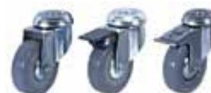
**Schg** — колесные опоры поворотные и поворотные с тормозом, контактный слой из литой серой резины, полипропиленовая ступица с защитными металлическими пыльниками, крепление под болт, втулка скольжения.
