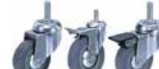
**Scs, Fcs** — колесные опоры большегрузные, термостойкие, неповоротные, поворотные, поворотные с тормозом, контактный слой из литой серой резины, болтовое крепление с резьбой, пластиковая ступица с защитными металлическими пыльниками, втулка скольжения.
