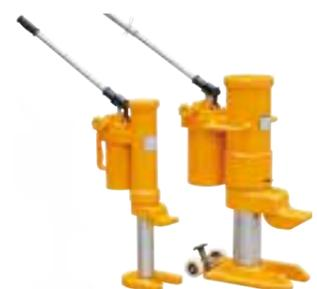
Домкрат гидравлический с лапой применяется для подъема груза, имеющего узкое пространство подхвата. Подъем производится маятниковым движением рычага, спуск осуществляется путём открытия вмонтированного в корпус клапана. Для нормальной эксплуатации домкрата гидравлического бутылочного и домкрата с лапой требуется присутствие необходимого количества рабочей жидкости (гидравлического масла) в его корпусе, являющимся направляющим цилиндром для штока.
