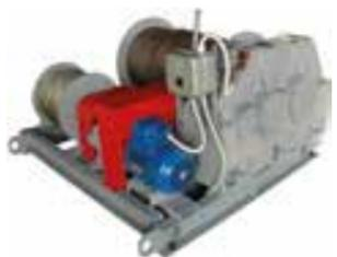
Электрическая лебедка представляет собой разновидность современного грузоподъемного оборудования, при помощи которого можно значительно облегчить подъем, опускание грузов, а также их перемещение в горизонтальной, вертикальной и наклонной плоскостях. Конструкция электролебедок включает электромотор и трос (цепь или канат), навивающийся на вращаемый двигателем барабан. Основное преимущество – более высокая скорость проведения складских, погрузочно-разгрузочных, строительно-ремонтных работ.
