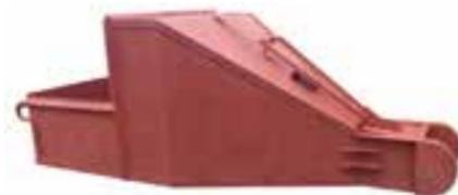
Загрузка строительной смеси в такую бадью производится в горизонтальном положении, а транспортировка — в вертикальном.
