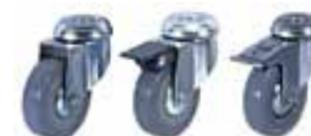
**Schg (b)** — колесные опоры поворотные и поворотные с тормозом, контактный слой из литой серой резины, полипропиленовая пластиковая ступица с защитными металлическими пыльниками, крепление под болт, втулка скольжения.
