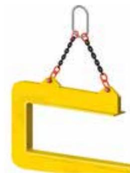
Предназначены для подъема и перемещения лестничных маршей. Предназначены для работы в паре, комплектуется предохранительной цепью. Длины строп подбираются таким образом, чтобы угол установки лестничного марша соответствовал заданному.
