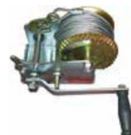
Применяются для подтягивания различных грузов, для удержания грузов при перевозке на прицепах, грузоподъемность лебедки рассчитывается как 75% от тягового усилия. Лебедка не предназначена для удержания груза на высоте без дополнительного крепления груза.
