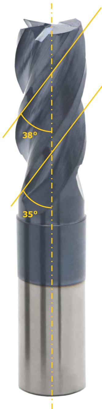
Четырехзубые фрезы с переменным углом подъема стружечных канавок 35 и 38 градусов и неравномерным шагом зубьев дают высокопроизводительно обрабатывают материалы при наличии вибраций и недостаточной жесткости системы СПИД.
