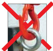
Нагрузка ограничена (захват макс. под углом 45° см. рис. А). При вращении груза рым-болт раскручивается – **опасность разрыва!**
