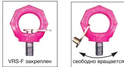
Для монтажа без использования дополнительных инструментов поставляется с интегрированным монтажным ключом (тип VRS-F). Простой монтаж: Вставить монтажный ключ во внутренний шестигранник – готово! Возможно закручивание и развинчивание вручную. Затем освободить головку винта – VRS-F вращается! Благодаря возможности устанавливать рым-болт в направлении действия нагрузки предотвращается непреднамеренное развинчивание!
